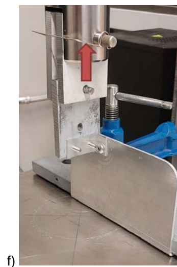
Figura B1.9: Ensaio ligação entre cantoneiras de altura e geometria variável (Ref. a CH-4.1/4.21/5.1/5.22) e cantoneira (Ref. a PR3) de ligação ao perfil de secção quadrada PR1.x: a) Formato 1 (PR4 – CH-5.1); b) Formato 2 (PR4 – CH-5.22); c) Formato 3 (PR4 – CH-4.21); d) Formato 4 (PR4 – CH-4.1); e) Configuração do ensaio de tração; f) Configuração do ensaio de tração.
