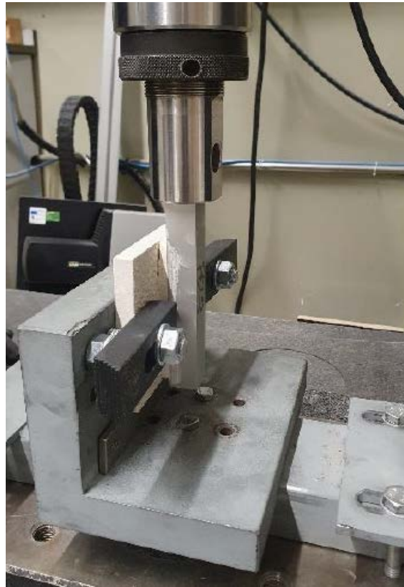
Figura B1.4: Ensaio de corte da ligação colada: Imagem de provete durante o ensaio.
