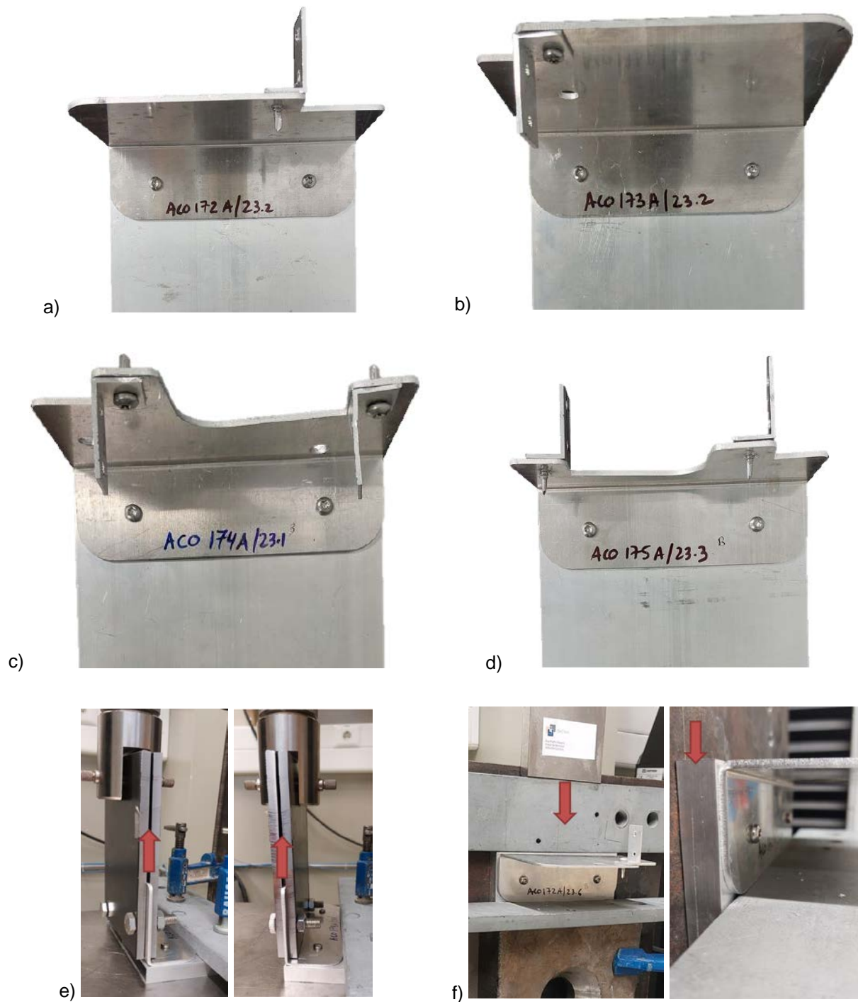
Figura B1.8: Ensaio da ligação entre perfil retangular (Ref. a PR4) e cantoneiras de altura e geometria variável (Ref. a CH-4.1/4.21/5.1/5.22) com aplicação dos esforços nas cantoneiras de altura e geometria variável: a) Formato 1 (PR4 – CH-5.1); b) Formato 2 (PR4 – CH-5.22); c) Formato 3 (PR4 – CH-4.21); d) Formato 4 (PR4 – CH-4.1); e) Configuração do ensaio de tração; f) Configuração do ensaio de tração.
