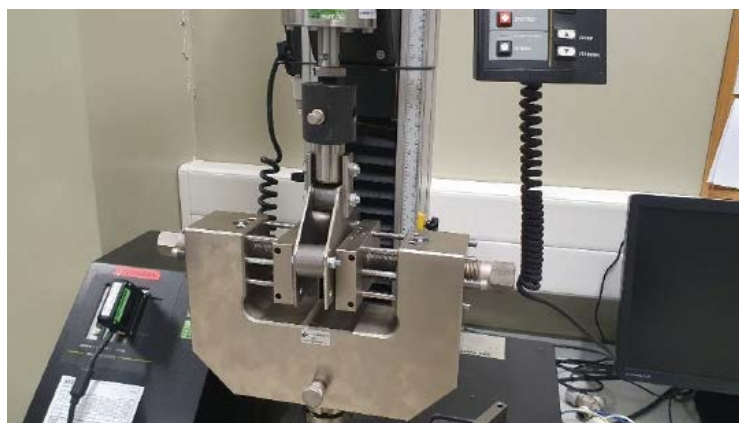
Figura B1.3: Ensaio de tração da ligação colada: a) Desenho esquemático da configuração; b) Imagem de provete durante o ensaio.
