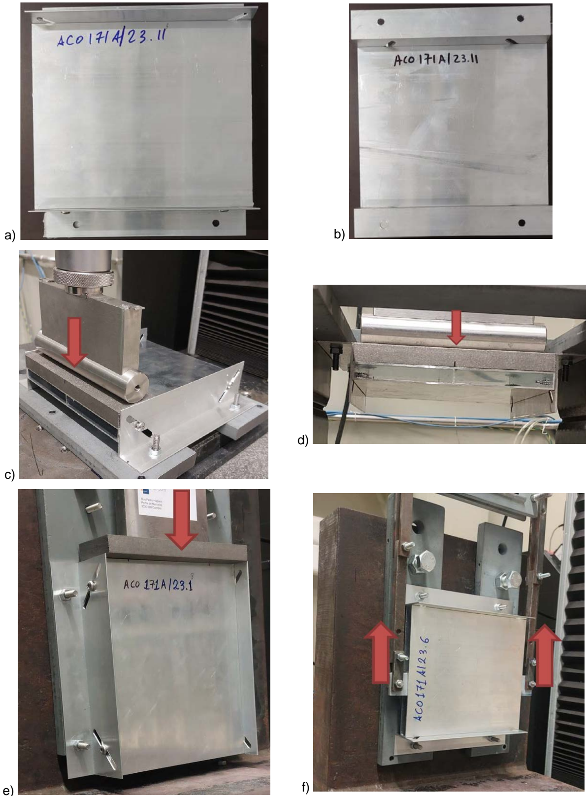
Figura B1.6: Ensaios da ligação entre perfil retangular (Ref. a PR4) e cantoneiras de ligação ao suporte [Ref. a PR5- x): a) Face superior; b) Face inferior; c) Configuração do ensaio de compressão; d) Configuração do ensaio de tração; e) Configuração do ensaio longitudinal; f) Configuração do ensaio transversal.
