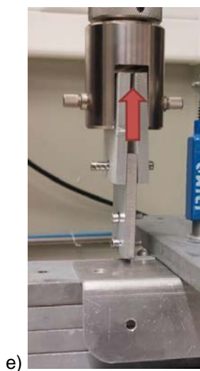
Figura B1.9: Ensaio ligação entre cantoneiras de altura e geometria variável (Ref. a CH-4.1/4.21/5.1/5.22) e cantoneira (Ref. a PR3) de ligação ao perfil de secção quadrada PR1.x: a) Formato 1 (PR4 – CH-5.1); b) Formato 2 (PR4 – CH-5.22); c) Formato 3 (PR4 – CH-4.21); d) Formato 4 (PR4 – CH-4.1); e) Configuração do ensaio de tração; f) Configuração do ensaio de tração.
