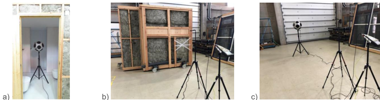
Figura 19: Posicionamento do equipamento de medição e de geração de ruído: a) Fonte sonora omnidirecional no interior do POD; b) Equipamento de medição no exterior do POD; c) Fonte sonora omnidirecional e equipamento de medição.
