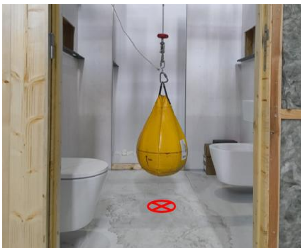
Figura 9: Ensaio de impacto ao pavimento.
