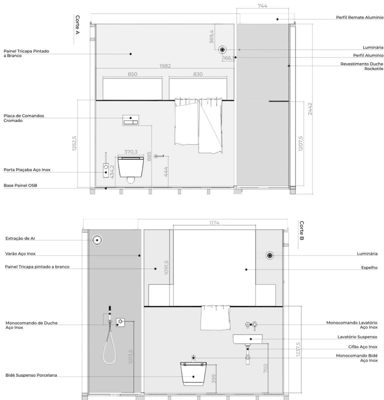
Figura 7: Corte A e B do POD com a indicação dos seus componentes (dimensões em mm).
