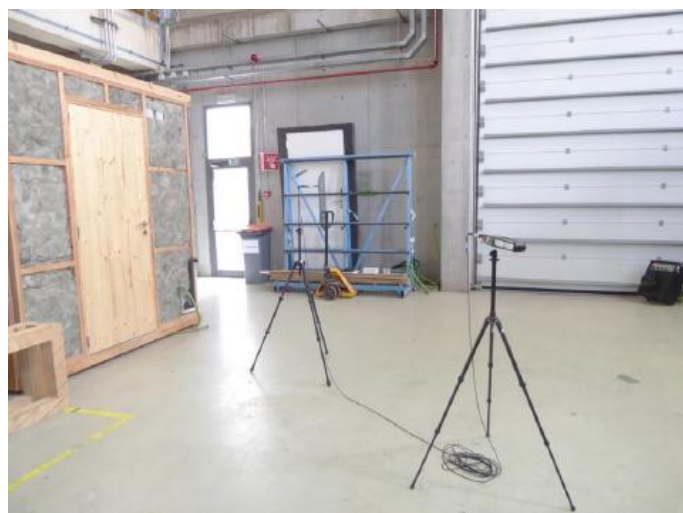
Figura 16: Disposição do equipamento de ensaio utilizado para a realização das medidas acústicas exteriores.
