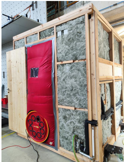
Figura 24: Registo fotográfico do ensaio de permeabilidade ao ar – Blowerdoor test.
