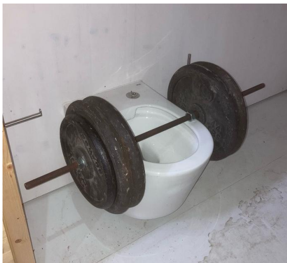
Figura 12: Aplicação da carga vertical excêntrica na sanita a 353 mm da face da parede do POD.
